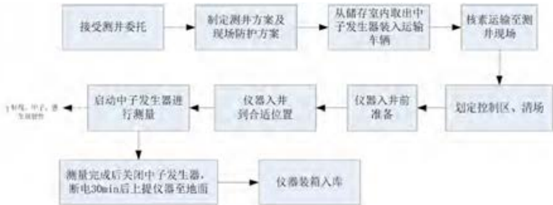
图2-9 中子发生器测井工作流程及产污环节示意图
